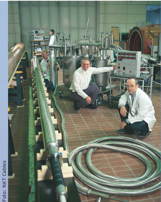
Figur 10. Superledende kabel testes på DTU.
