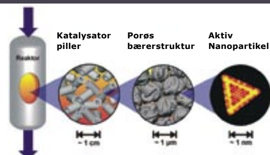
Figur 11 Et kig ind i en reaktor fyldt med en katalysator formet som piller af et porøst bærermateriale, hvorpå de aktive, få nanometer brede nanopartikler sidder.
